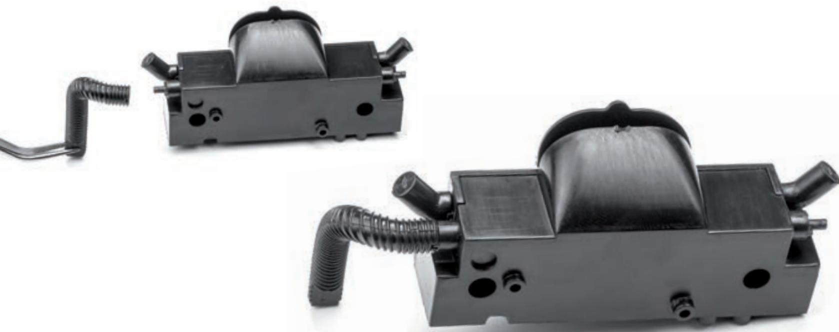
**Шаг 6.** На более длинных крепежных штифтах корпуса отопителя закрепите соответствующие шланги обдува ветрового стекла. Проверьте правильность монтажа деталей: шланги обдува ветрового стекла должны быть направлены вверх, а короткие патрубки — вниз и в стороны.
